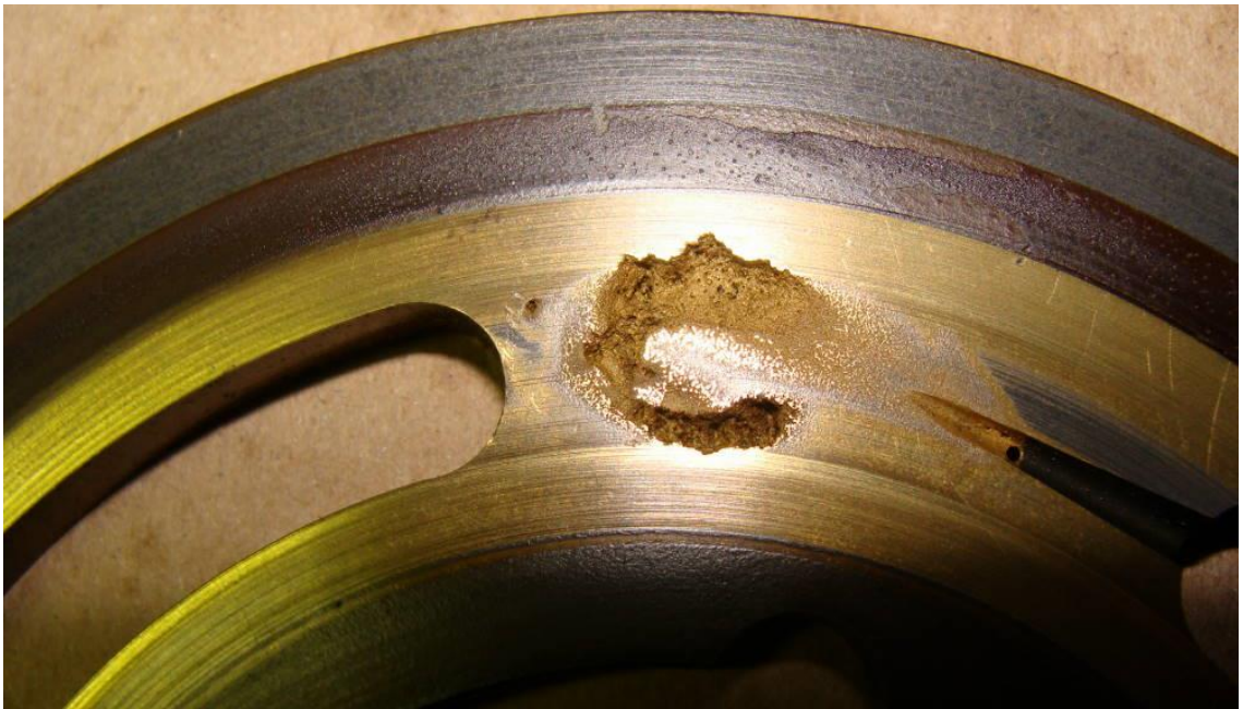
Slika 22 oštećenje nastalo kavitacijom [14]
