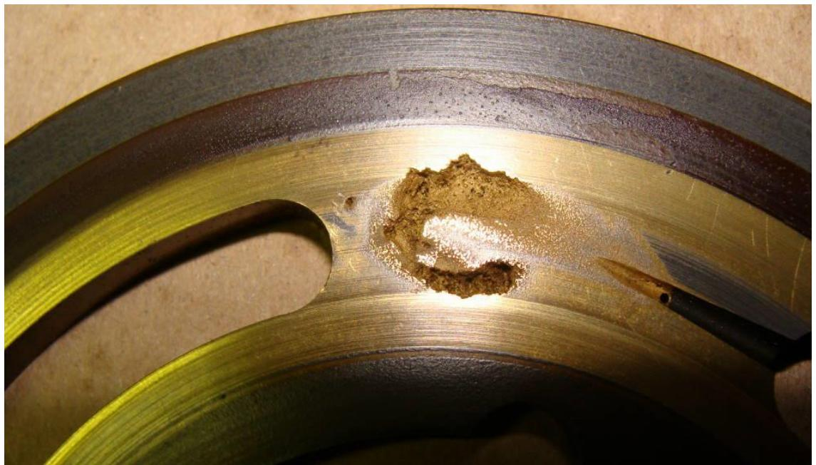
*Slika 22 oštećenje nastalo kavitacijom [14]*
