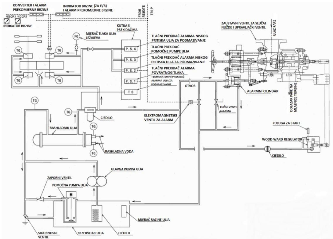
Slika 17 shema sustava ulja za podmazivanje [7]
