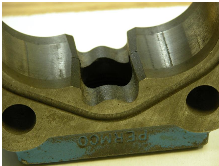
Slika 5.12. - Primjer postojanja manje kontaminacije u pumpi
