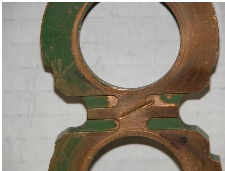
Slika 5.13. - Kontaminacija koja sa vremenom obod pumpe izgrebe u mjeri nalik pjeskarenju
