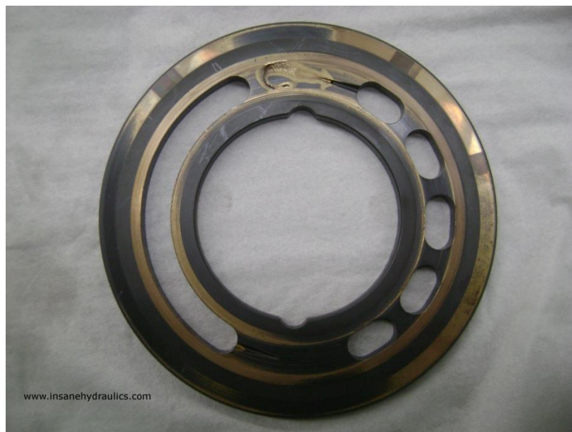
Slika 5.7. - Oštećenje razvodne ploče klipne pumpe uslijed djelovanja kavitacije ili aeracije
