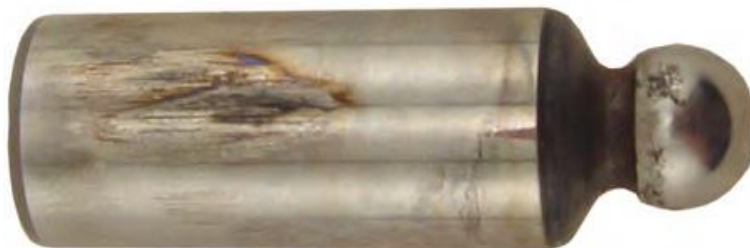
Slika 5.1. - Pojava zapaljenja klipa zbog gubitka podmazivanja koje stvara velike temperature
