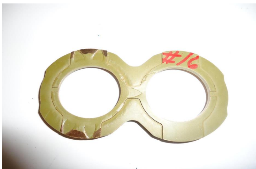
Slika 5.16. - Pumpa pretegnuta u toj mjeri da zupčanik naliježe na obod pumpe
