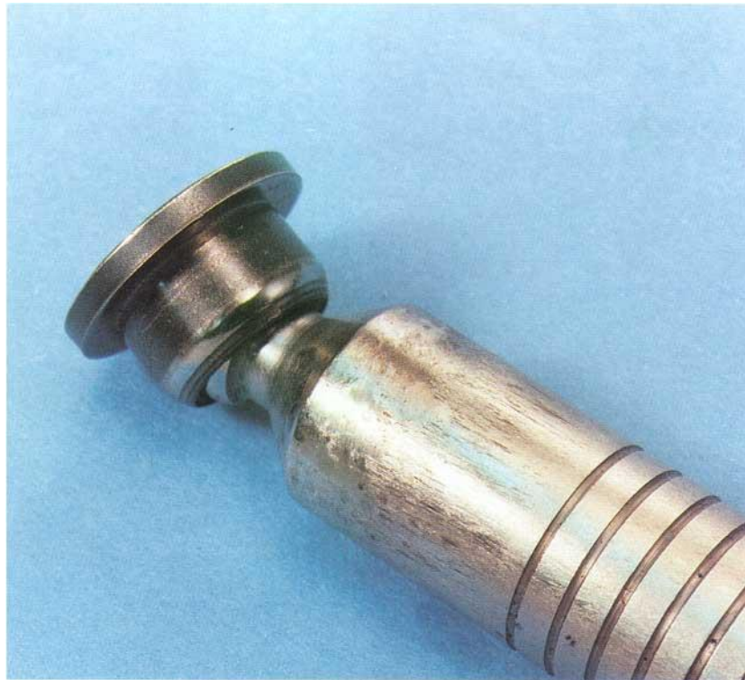
Slika 5.4. - Oštećenje klipa uslijed nedovoljnog ili gubitka podmazivanja
