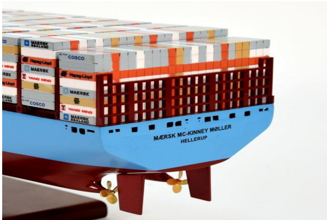
Slika 8. Krmena struktura novih generacija kontejnerskih brodova [20]
