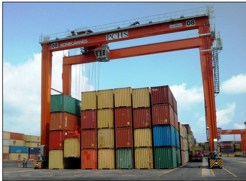
Slika 8 Kontejnerski blok slagališta opremljen RTG dizalicom
