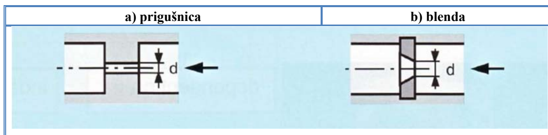
Slika 4-19. Načini usporavanja protoka fluida [6, p. 101]
