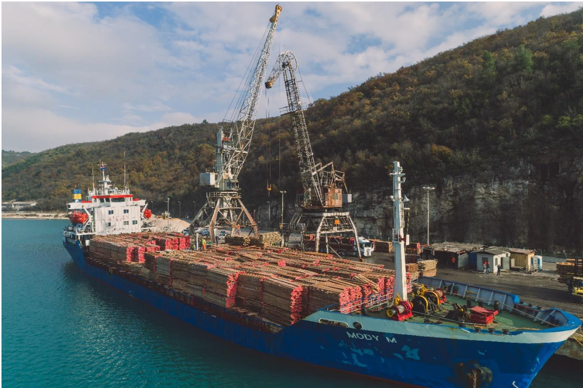
Slika 6. Brodska dizalica za rukovanje teretom drva
