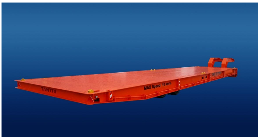
Slika 8.: RO-RO spuštена prikolica
