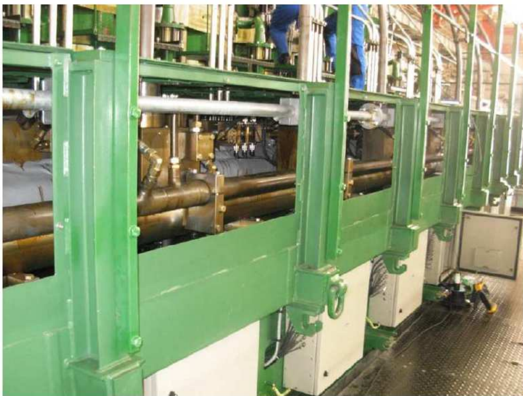
Slika 23. Rail jedinica na motoru [2]
