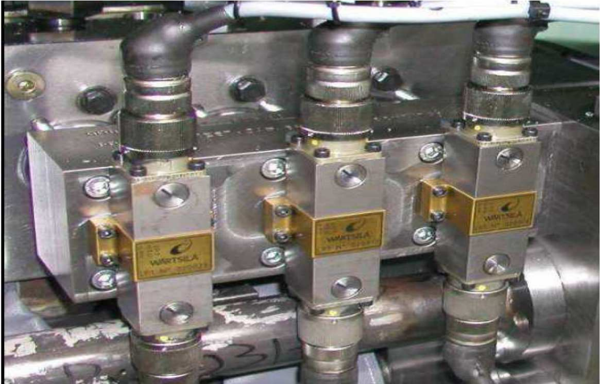
Slika 33. Rail ventili na ICU jedinici [2]
