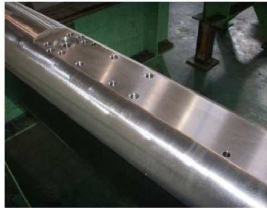
Slika 24. Zajednička Rail cijev goriva [2]
