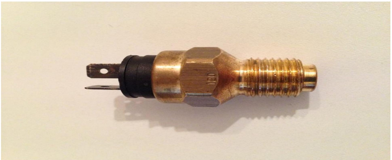
Slika 6. Senzor temperature motora
