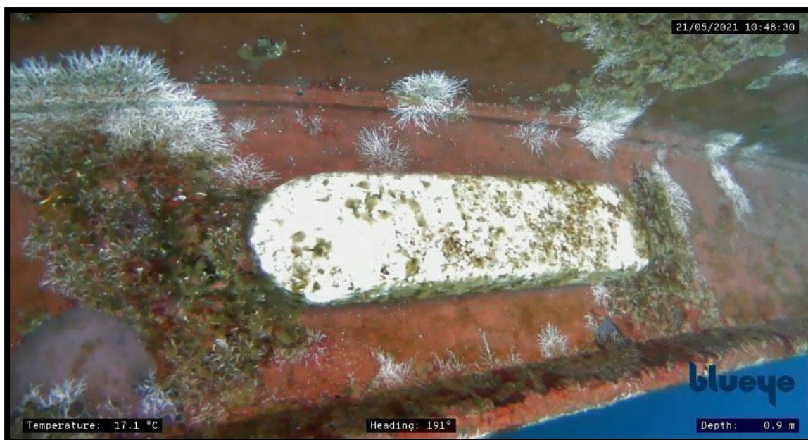
Slika 21. Žrtvena anoda na ljuljnoj kobilici
