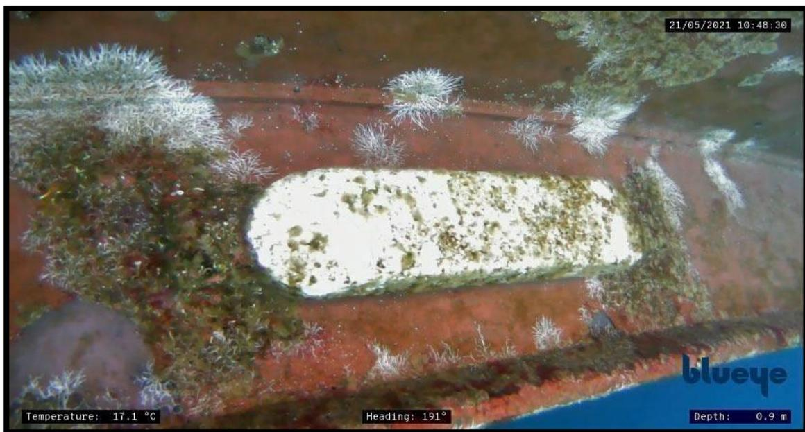
**Slika 21. Žrtvena anoda na ljuljnoj kobilici**
