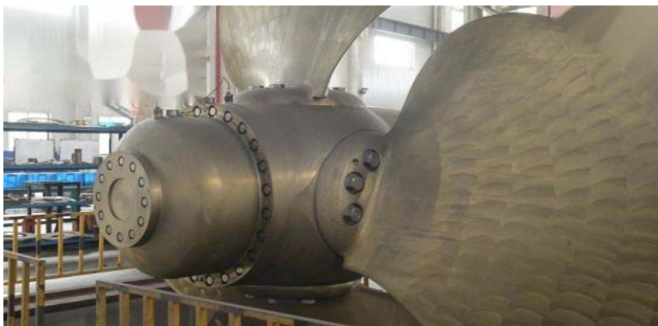
Slika 3: Brodski vijak s prekretnim krilima (CPP) [14]
