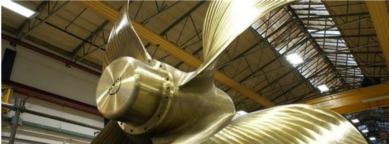
Slika 2: Brodski vijak s fiksnim krilima (FPP) [14]
