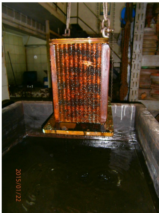
Slika 31. Metoda čišćenja rashladnika zraka u kadi s otapalom [11]
