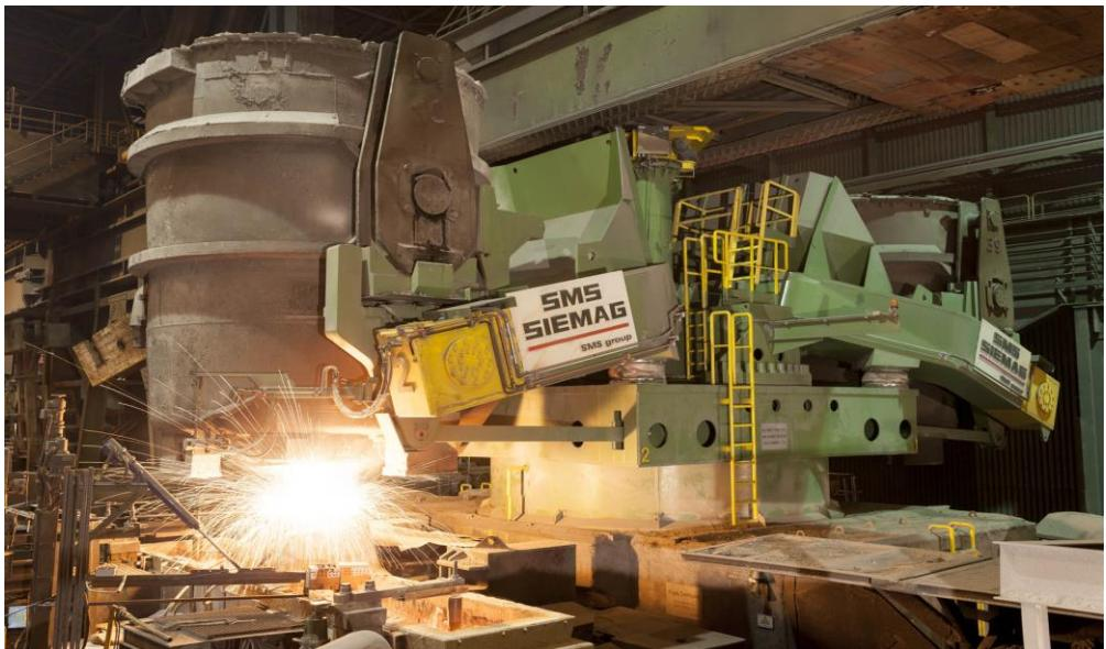
Slika 5: Rotacijski toranj SMS Siemag
