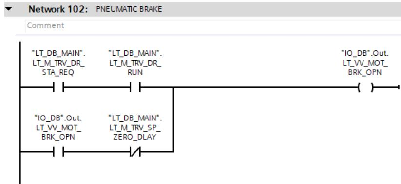
Slika 29: Pneumatska kočnica
