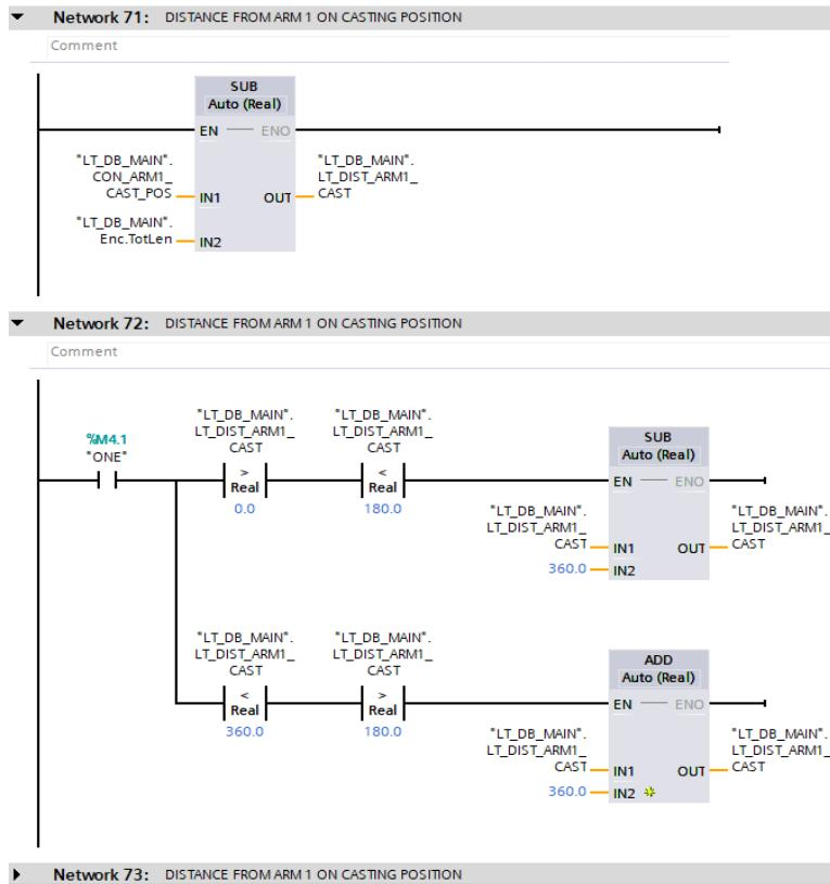
Slika 28: Određivanje udaljenosti od pozicije za lijevanje
