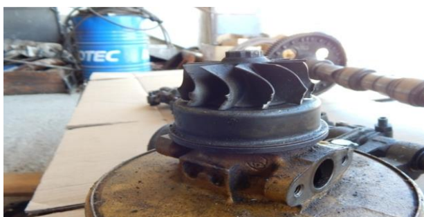
Slika 20. Oštećene lopatice turbine pogonskog motora
