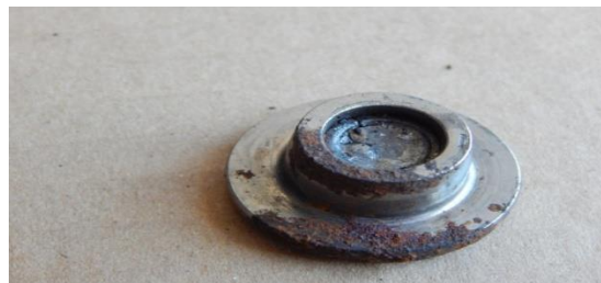
Slika 16. Pogled na oštećen - polomljen deo stabla izduvnog ventila na šestom cilindru pogonskog motora sa svojim osiguračem u svom repnom delu
