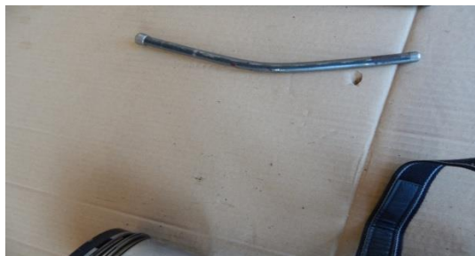
Slika 15. Deformisana šipka podizača izduvnog ventila na šestom cilindru pogonskog motora
