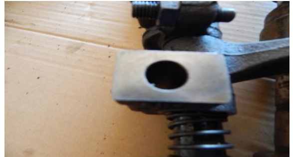
Slika 8. Pogled na neoštećenu drugu površinu nosača klackalica koja dodiruje glavu iznad šestog cilindra, pogonskog motora - radi upoređenja sa oštećenom površinom
