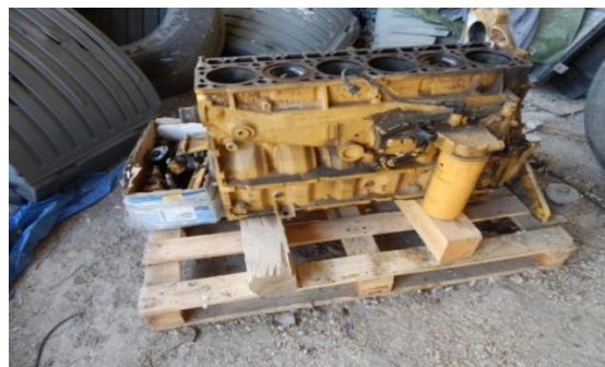
Slika 4. Pogonski motor - blok havarisanog motora
