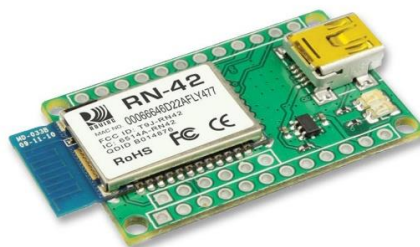
Slika 15. RN 42 EK Bluetooth modul [15]
