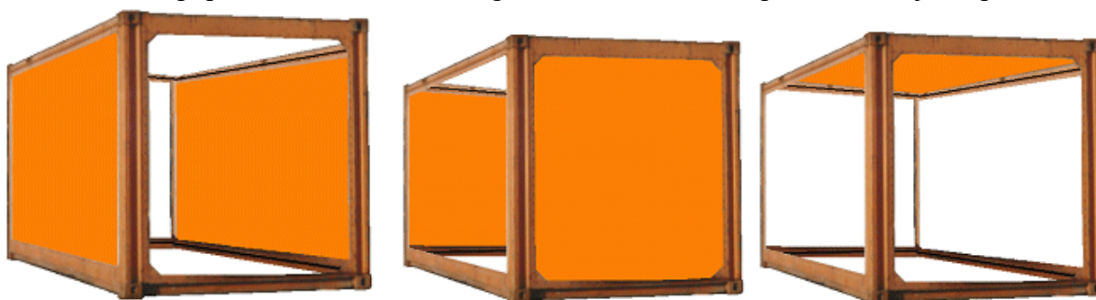
Slika 5 Bočne stijenke. Čelone stijenke i krov kontejnera
