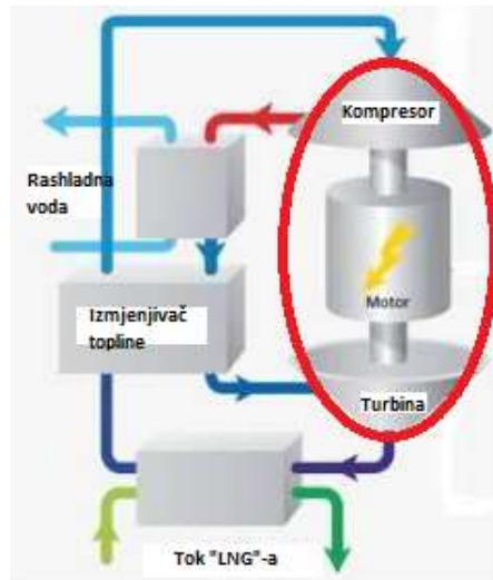
Slika 6: Smještaj aktivnih elemenata na istoj osovini u sustavu [1]
