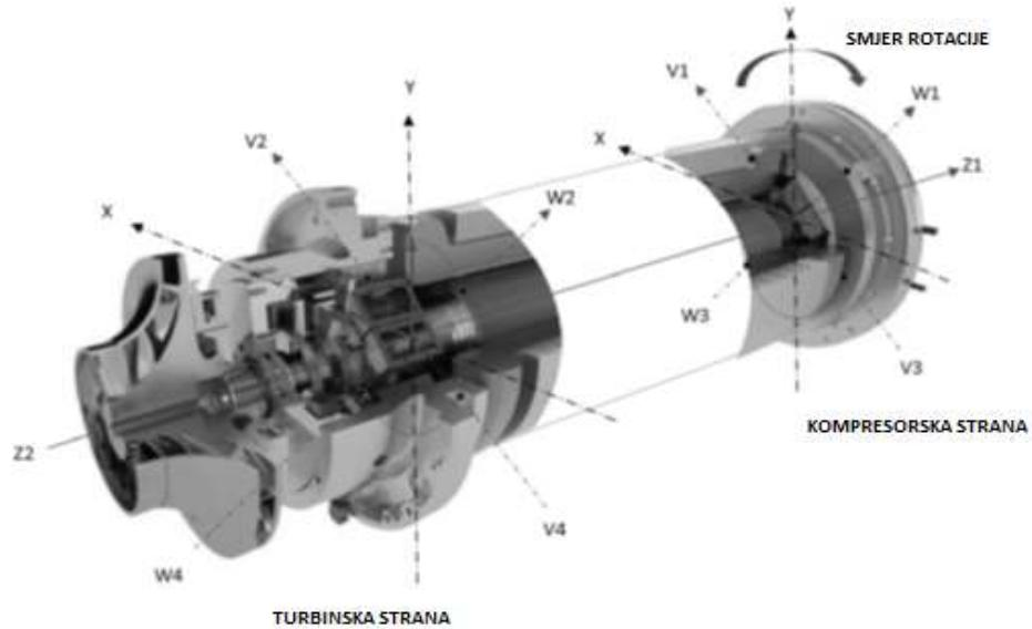
Slika 11: Presjek kućišta turbine i magnetskog ležaja [1]
