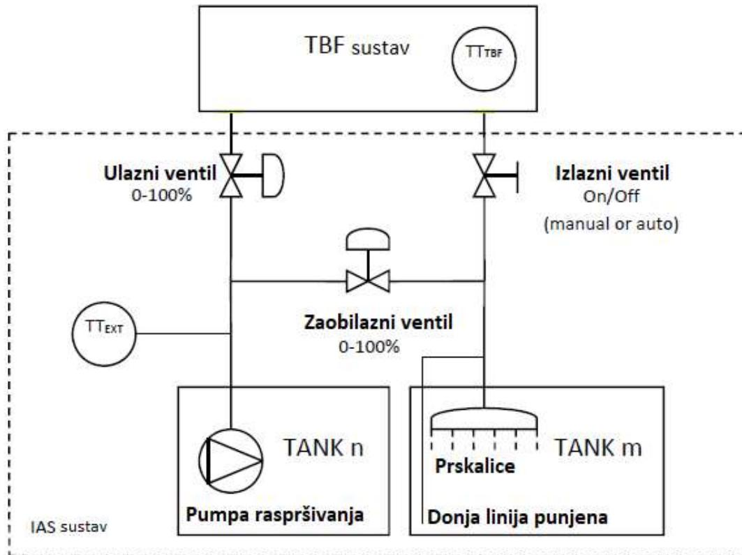
Slika 25: Shematski prikaz povezivanja sustava pothlađivača i tankova [1]
