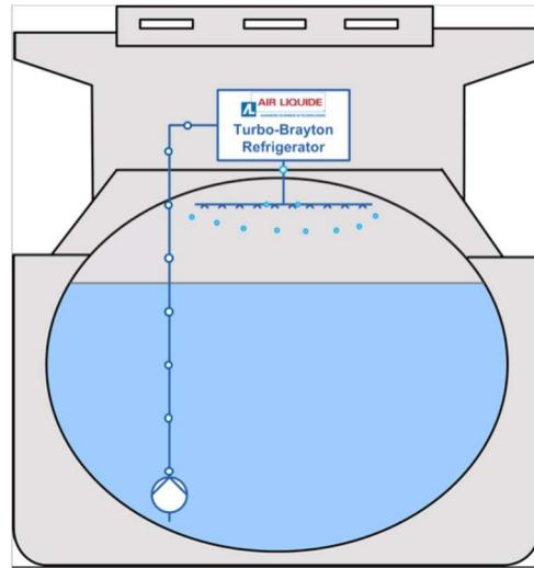
Slika 22: Integracija pothlađivanja "Turbo-Brayton"-ovim sustavom na "LNG"-u [3]
