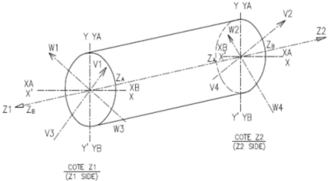
Slika 10: Shematski prikaz osi magnetskog ležaja [6]
