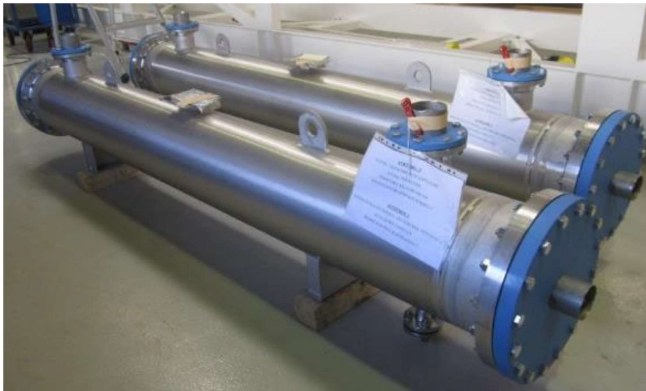
Slika 15: Cijevni izmjenjivač toplote u tvornici [1]
