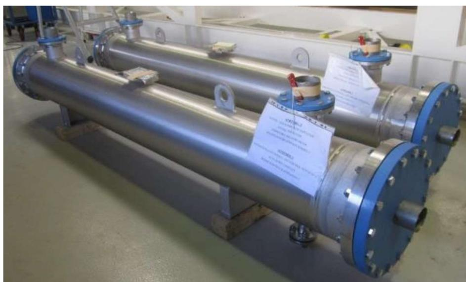
Slika 15: Cjevni izmjenjivač topline u tvornici [1]
