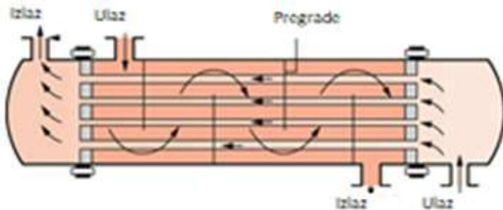
Slika 14: Presjek cjevnog izmjenjivača topline [6]
