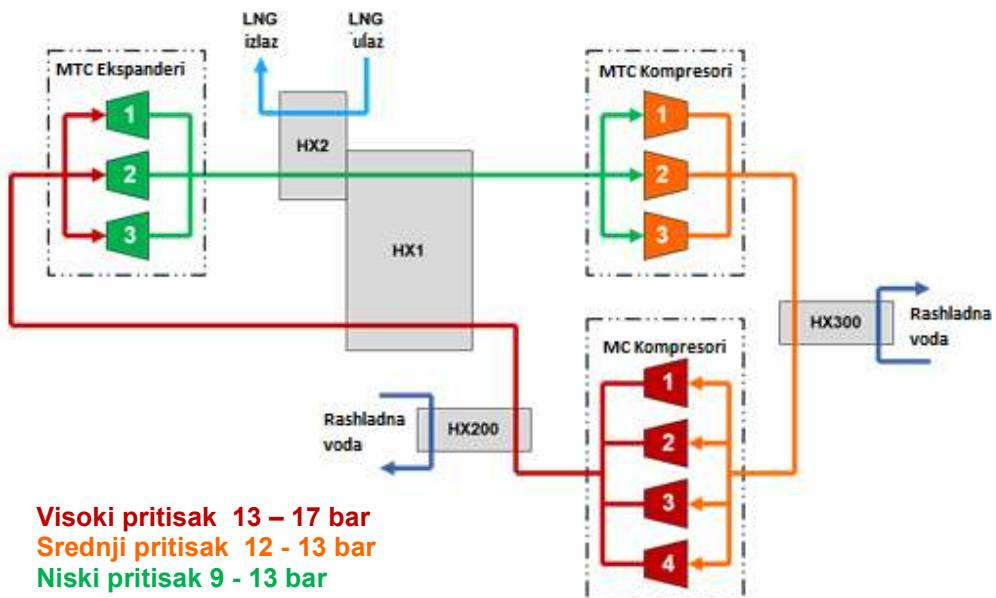
Slika 18: Shematski prikaz protoka rashladnog plina u „subcooler“-u [6]
