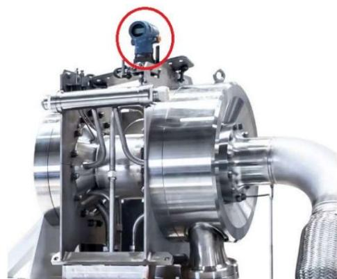
Slika 20: Diferencijalni ventil na "MC" kompresoru [1]
