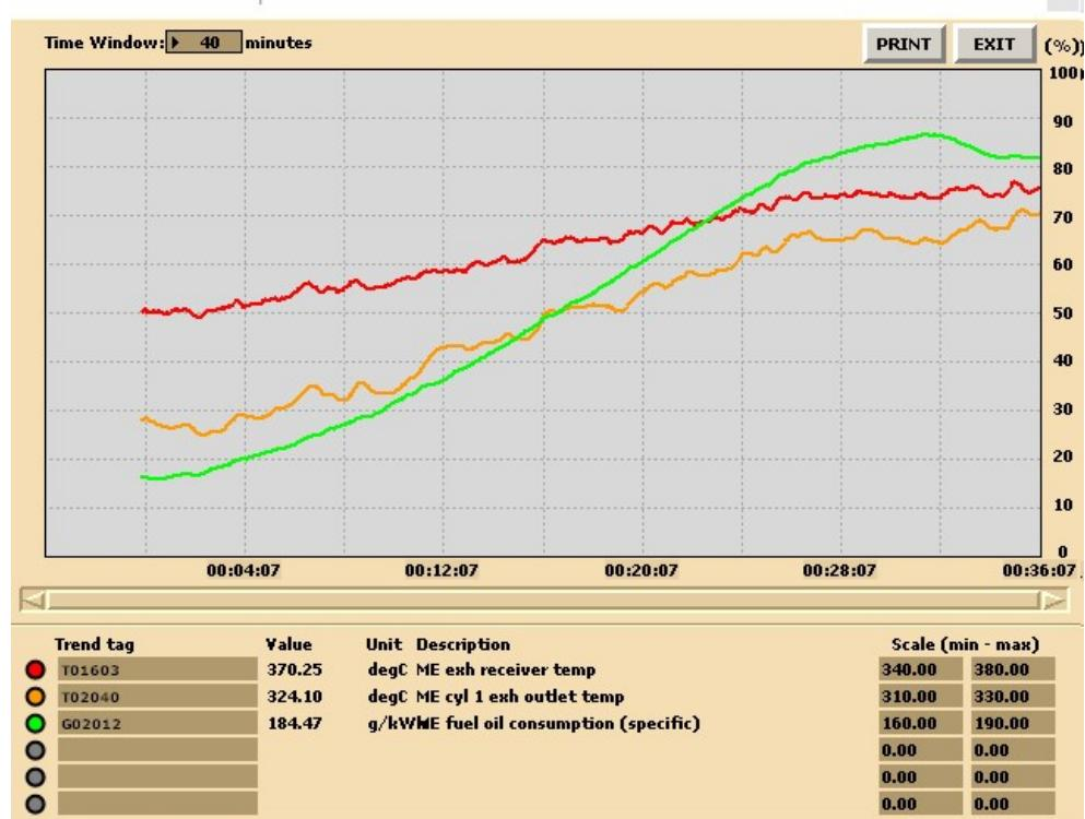
Slika 4. Graf temperature na cilindru 1, temperature prije turbo puhala i specifične potrošnje goriva tijekom prebacivanja goriva
