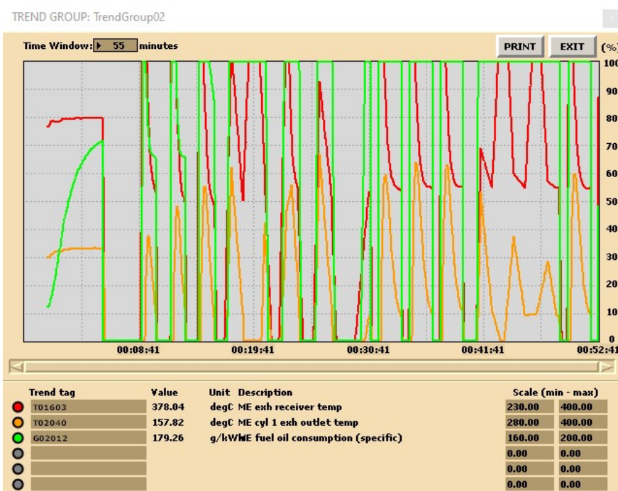
Slika 11. Graf temperature na cilindru 1, temperature prije turbo puhala i specifične potrošnje goriva tijekom prebacivanja goriva kod prenamernog prebacivanja goriva
