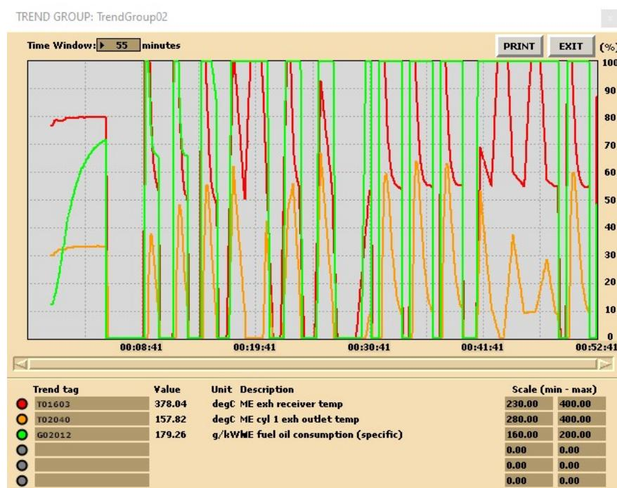
Slika 11. Graf temperature na cilindru 1, temperature prije turbo puhala i specifične potrošnje goriva tijekom prebacivanja goriva kod prenaglog prebacivanja goriva
