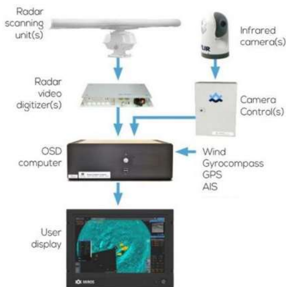
Slika 40. Tijek rada Miros OSD sustava
