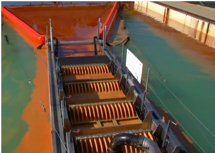
Slika 34. Skimer diskovi tijekom uklanjanja ulja iz vode
