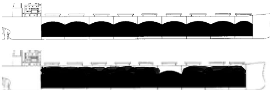
Slika 4. Raspored rasutog tereta po skladištima
