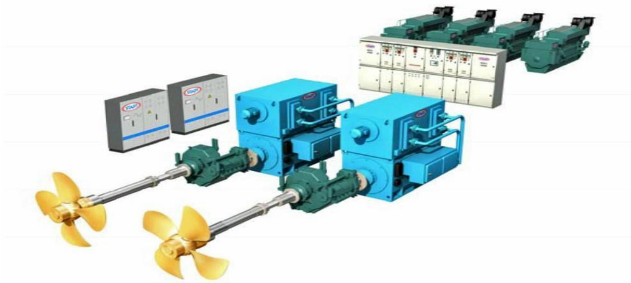
Slika 11 Prikaz dizel- električne propulzije
