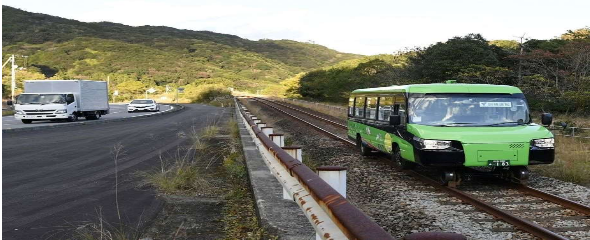
Slika 9. Prikaz vođenog busa na tračnicama
