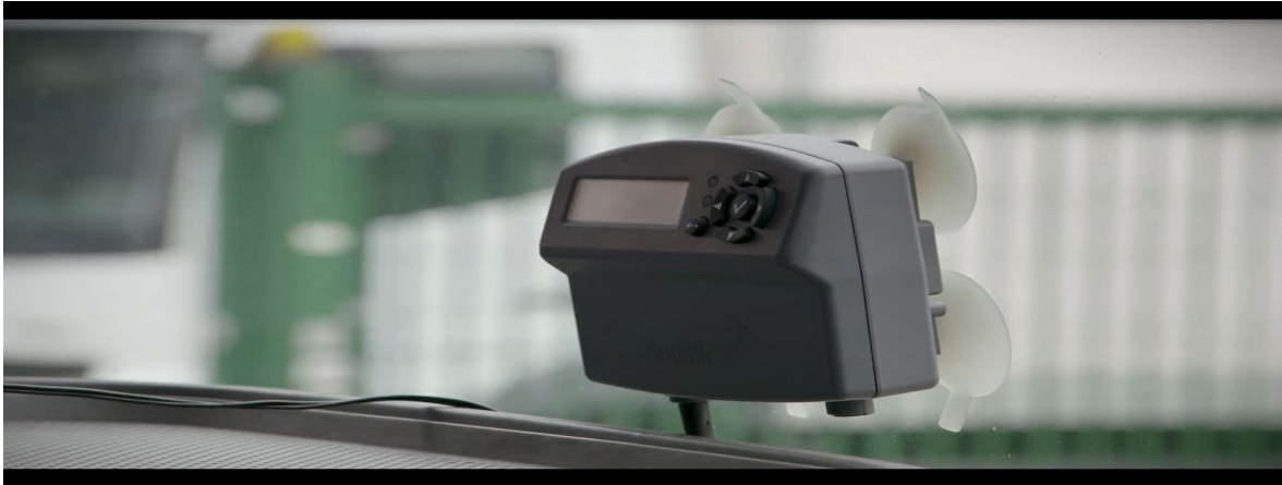
Slika 24. Prikaz OBU elektronske jedinice u autima
