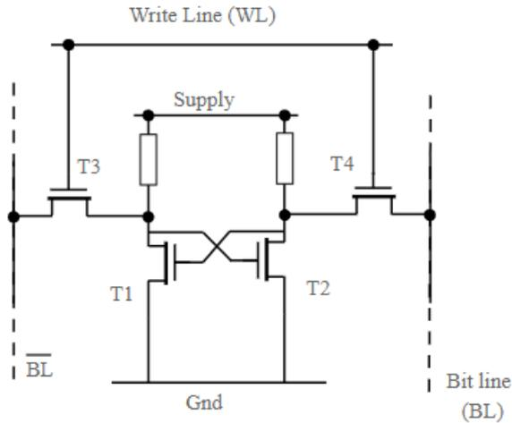
**Slika 1. Struktura SRAM memorijske ćelije sa četiri tranzistora**
