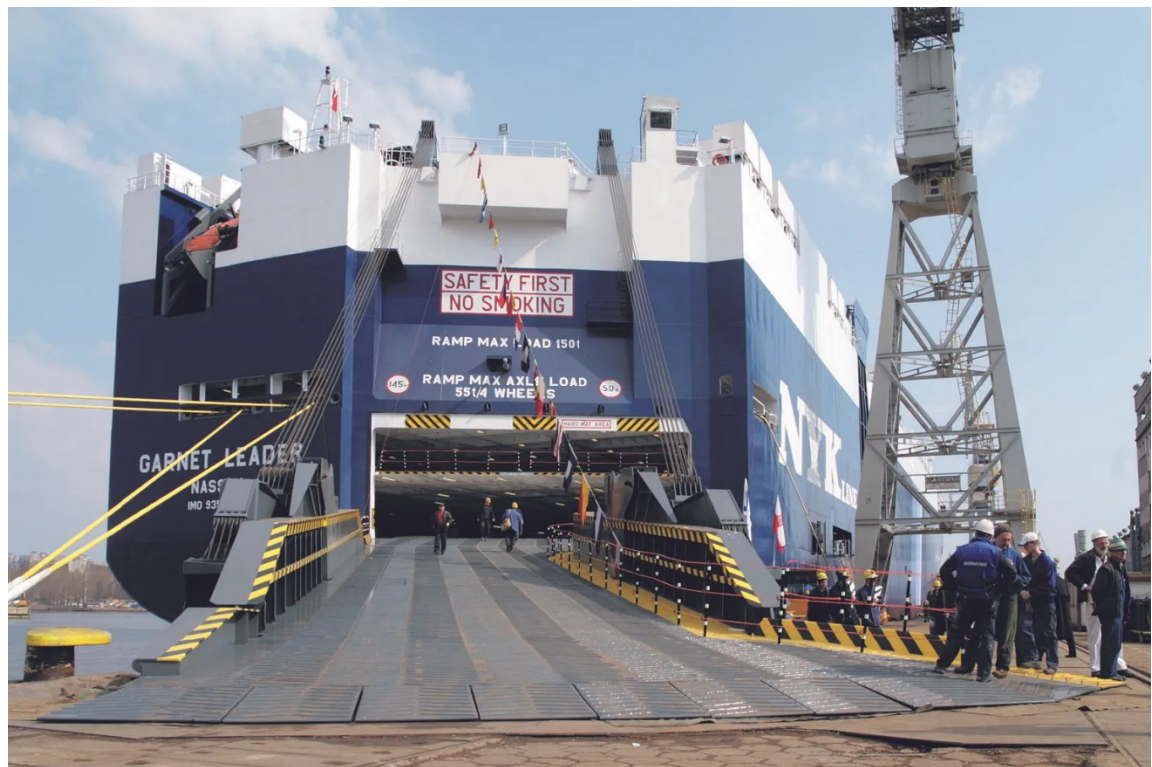
Slika 2. Primjer rampe na krmi broda
