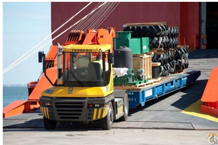
Slika 9. RO-RO tegljač sa priključenom RO-RO prikolicom.
