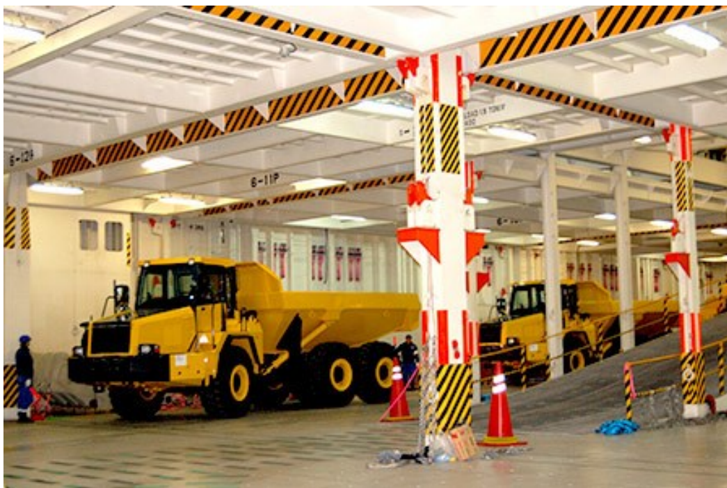
Slika 4. Građevinski strojevi unutar RO-RO broda
