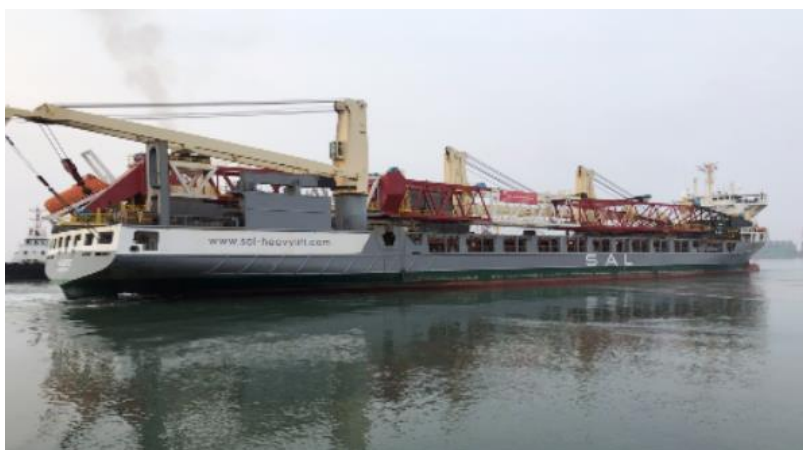
Slika 7. Nosač velike dizalice na palubi broda
