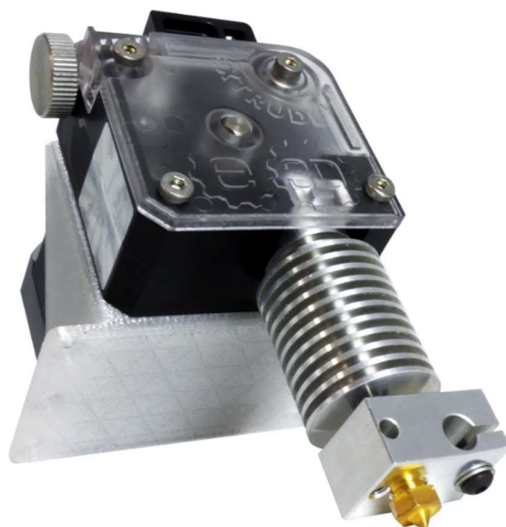
Slika 30. Ekstruder i ispisna glava povezani Direct Drive sustavom
