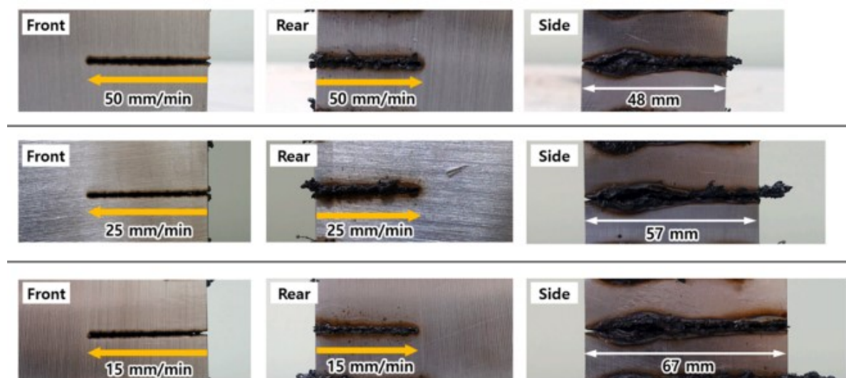
Slika 26. Prikaz uzoraka izrezanih pod kutem od 5°
