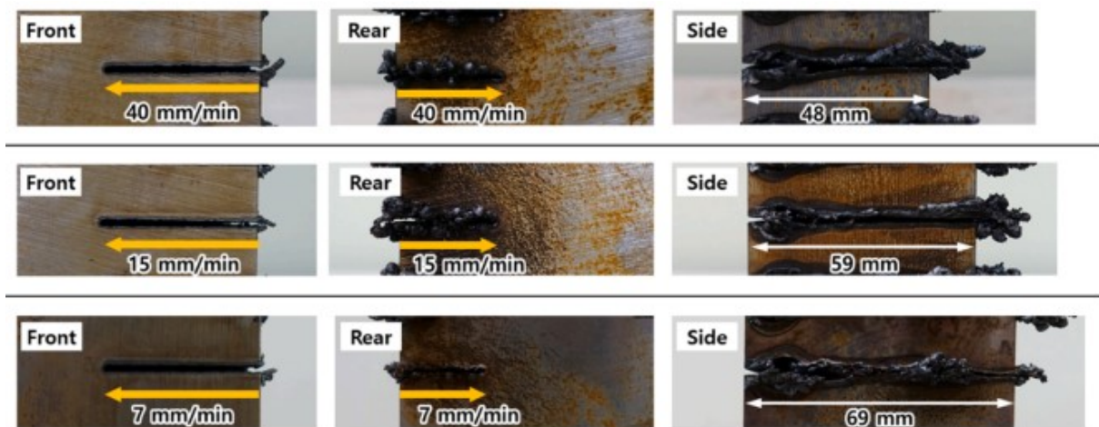
Slika 28. Prikaz uzoraka ugljičnog čelika rezanog pod kutem 15^\circ
