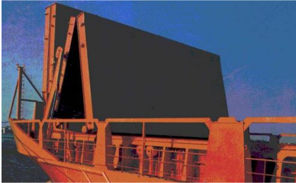
Slika 14. Člankasti sklapajući poklopci na izloženoj palubi
