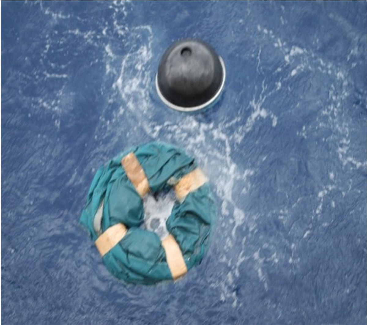
Slika 9. Langrangeova plutača na morskoj površini [14]. (Izvor: https://www.adp.noaa.gov/ )
