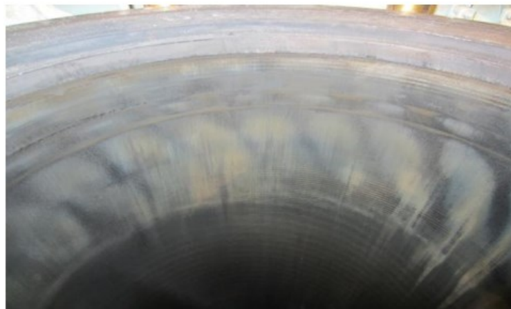
Slika 13: Hladna korozija u gornjem dijelu košuljice [12]
