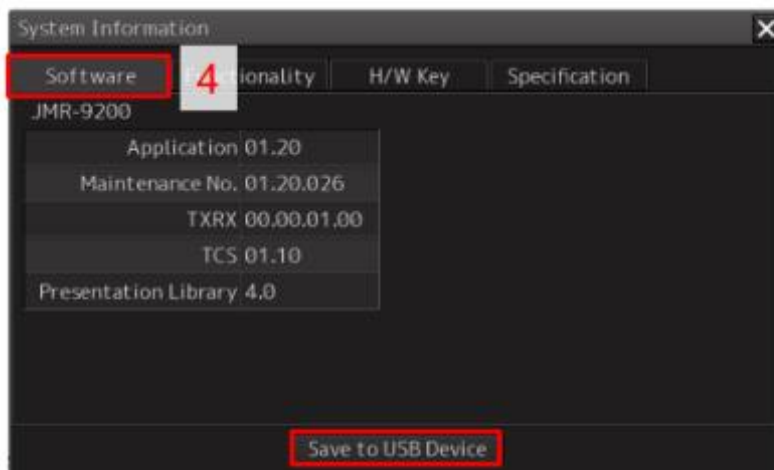
Slika 42. Postupak dobivanja podataka o verziji operacijskog sustava unutar JRC ECDIS sustava
