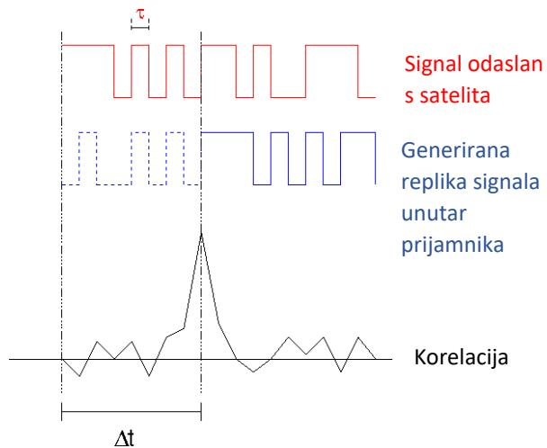
Slika 4. Proces korelacije primljenog i generiranog kodiranog signala
