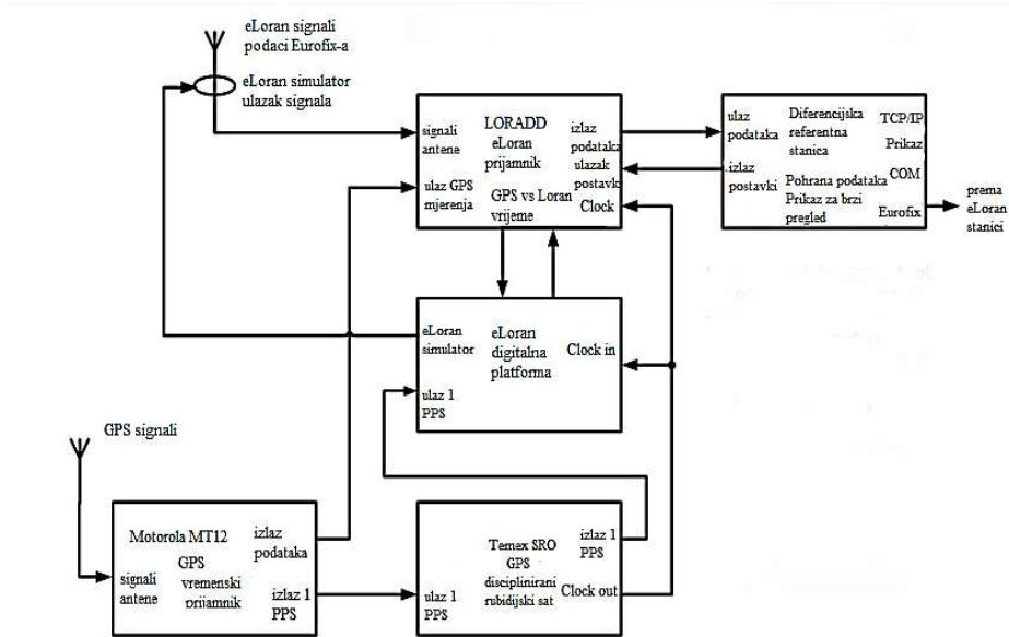
**Slika 19. Funkcionalni dijagram diferencijalne e-Loran referentne stanice**
