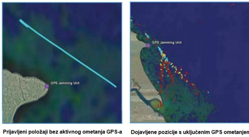
**Slika 15. Prikaz položaja jedinica bez i sa uključenim GPS ometanjem**
