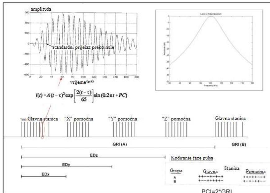
**Slika 7. Struktura e-Loran signala i frekvencijski spektar**
