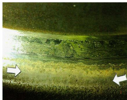
Slika 9. Oštećeni i nagoreni pladanj ispušnog ventila te prikaz visoko-temperaturne korozije nakon 33 000 radnih sati [10]
