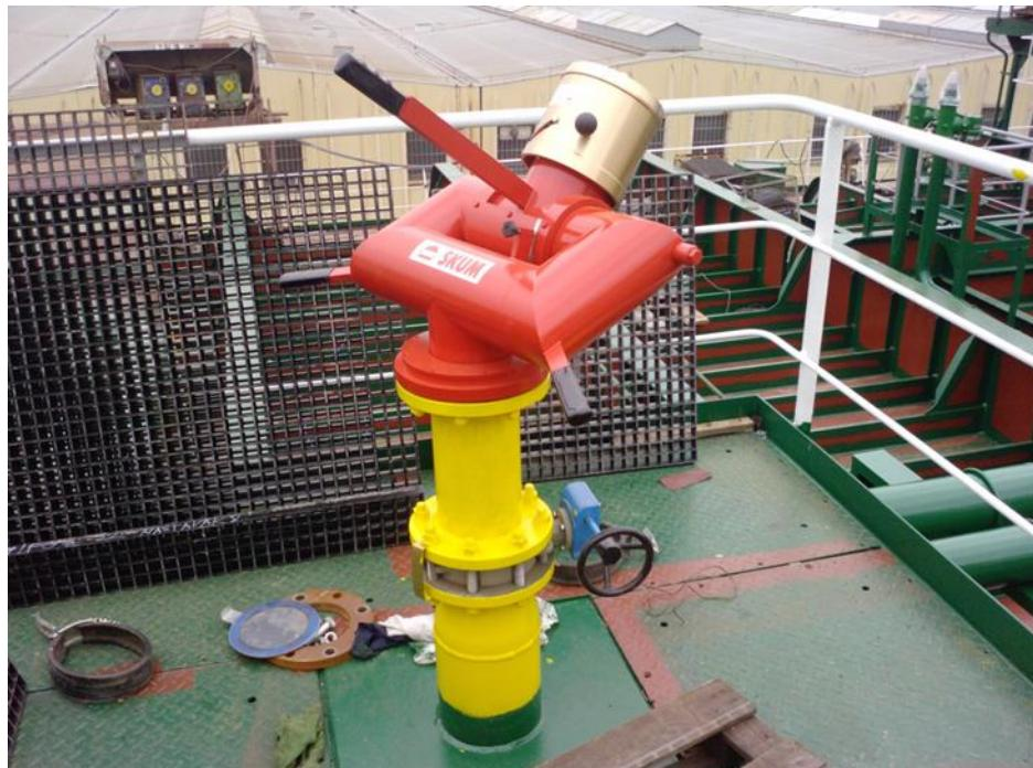
**Slika 8 Monitor za gašenje požara na palubi**
