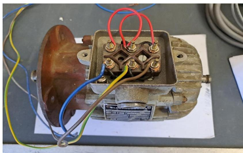
Slika 22: Prikaz spojenoga trofaznoga asinkronoga motora
