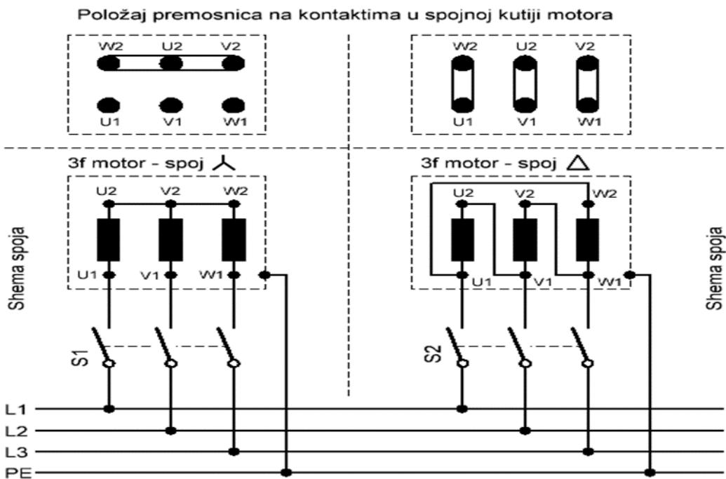
Slika 2: spojna shema trofaznog asinkronog motora
