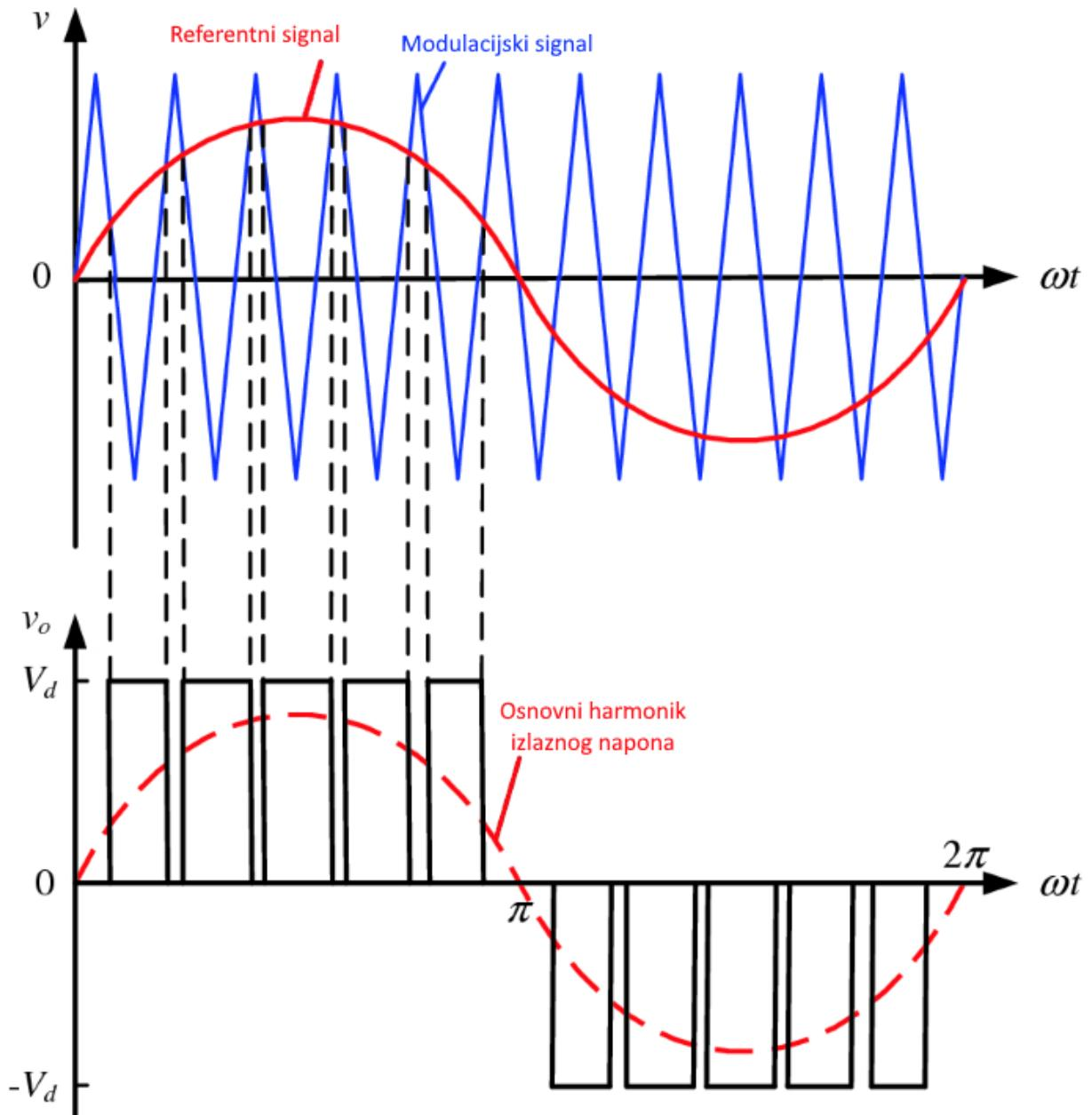
Slika 13: Valni oblik izlaznog napon trofaznog izmjenjivača (za jednu fazu)
