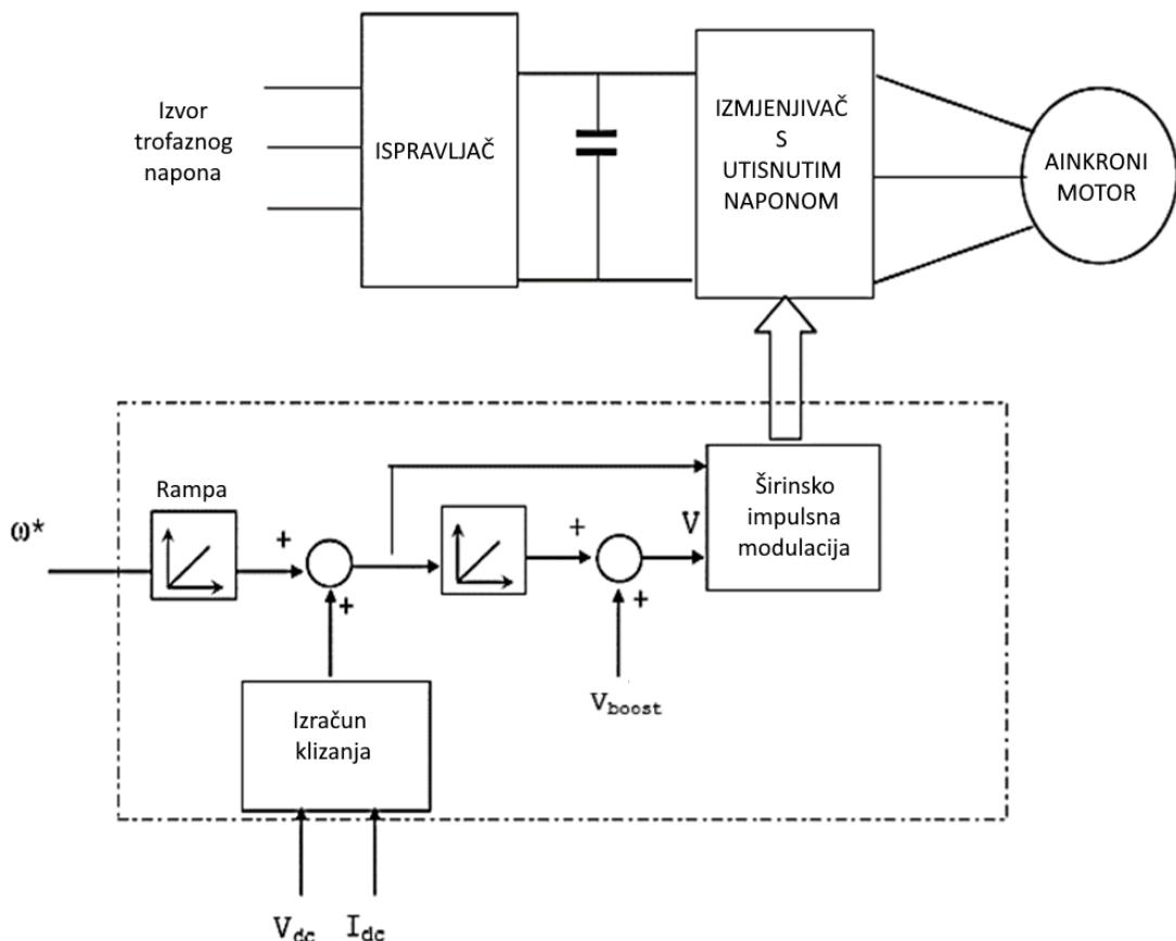
Slika 19: Blok dijagram upravljanja otvorenom petljom
