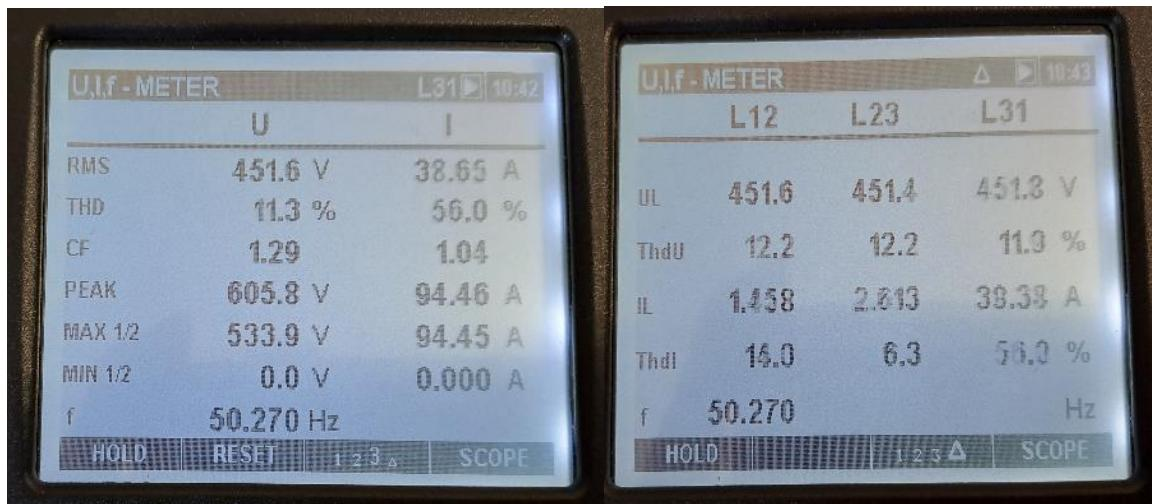
Slika 35: Mjerenje U, I, f pri frekvenciji 50Hz
