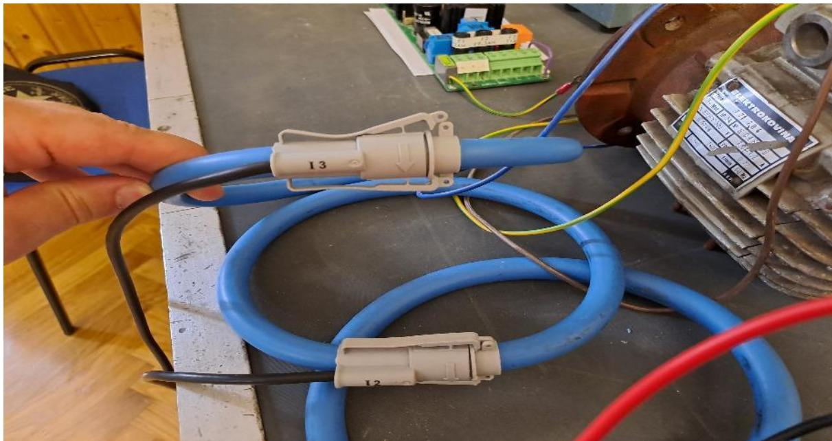
Slika 30: Strujna mjerna kliješta
