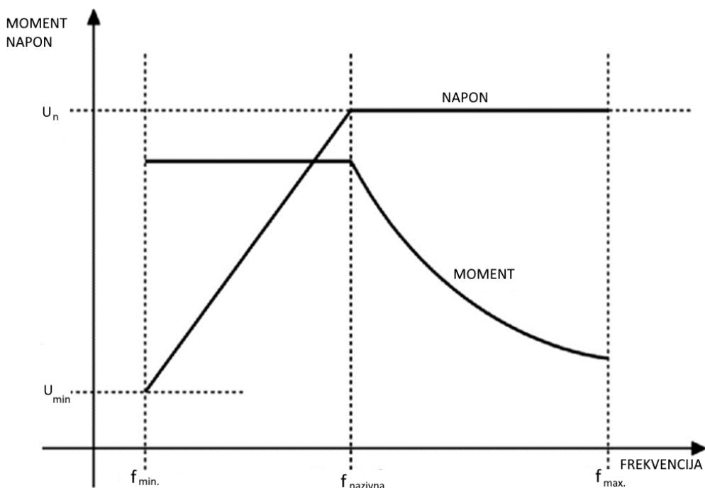
Slika 17: V/f metoda regulacije brzine asinkronoga motora
