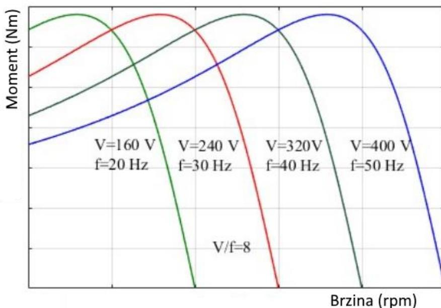
Slika 18: Momentne karakteristike pri različitom  $V/f$  omjeru
