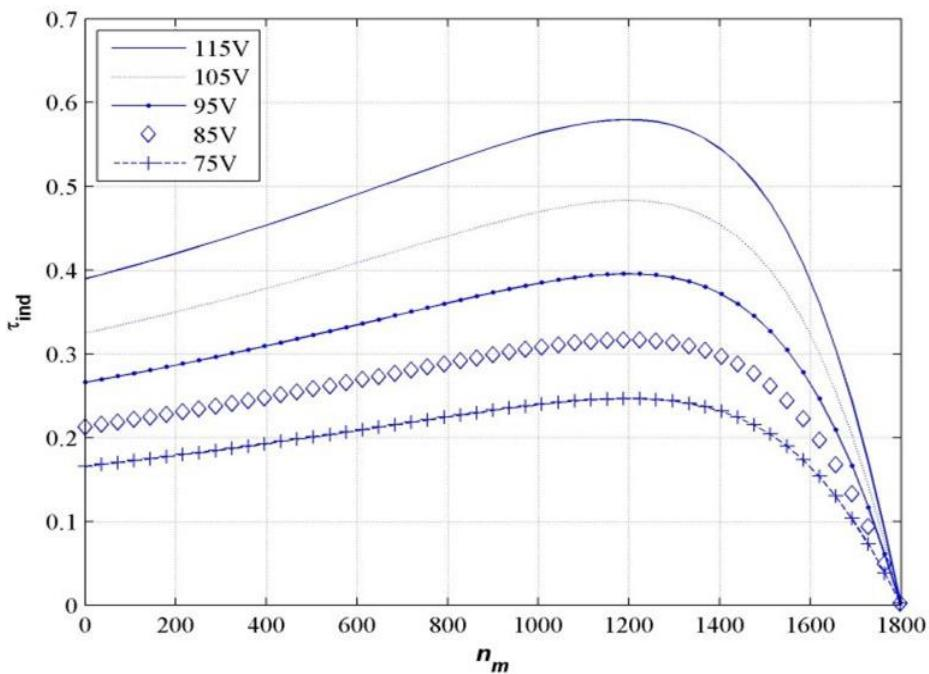
Slika 15: brzina asinkronoga motora s različitim vrijednostima napona
