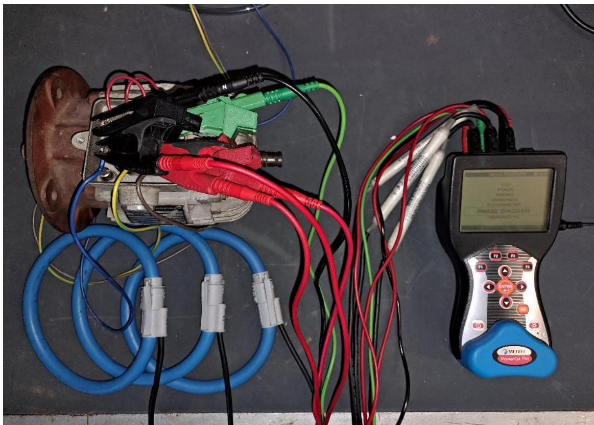
Slika 29: Prikaz kompletног spoja instrumenta i motora.
