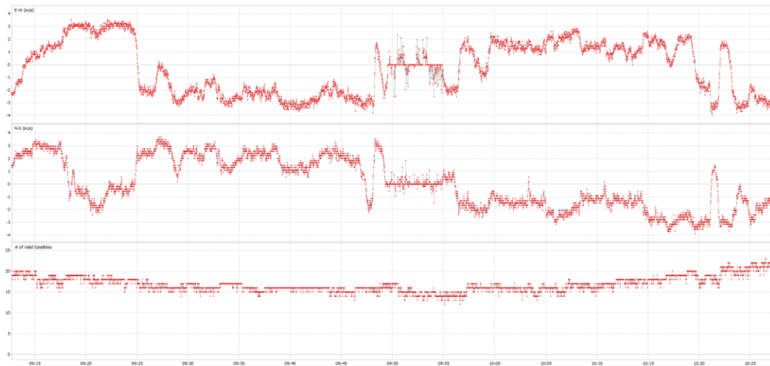
Slika 60. Prikaz brzine kretanja brodice i broj satelita, druga faza, Samsung A8, 09/05/2023
