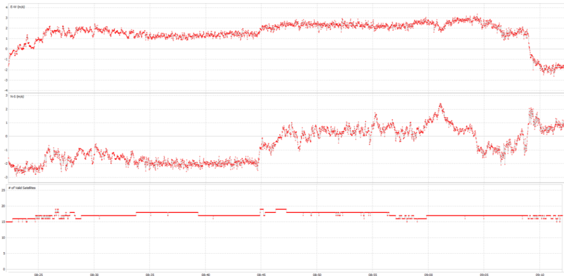
Slika 55. Prikaz brzine kretanja brodice i broj satelita, prva faza, Samsung S8, 09/05/2023
