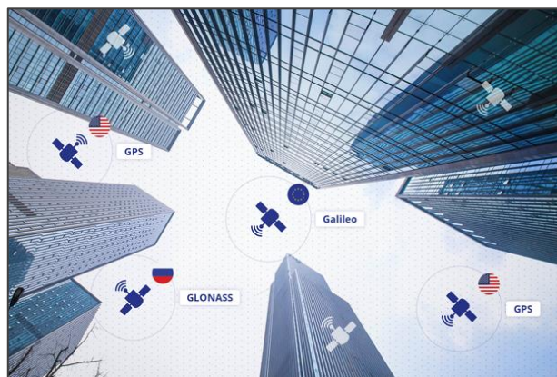
Slika 8. Primjer blokiranja signala satelita umjetnim tvorevinama
