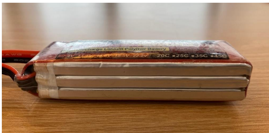
Slika 24. Prikaz oštećene baterije [23]
