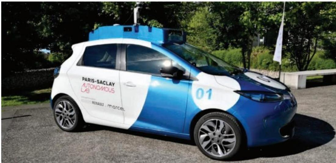
Slika 9. Primjer prototipa autonomnog vozila koji je razvila Grupa Renault za projekt EVAPS sa senzorom Velodyne UltraPuck LiDAR na vrhu
