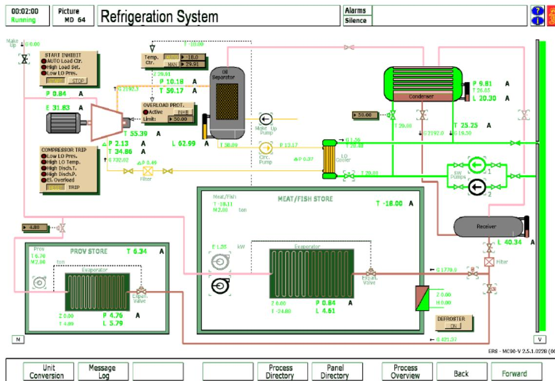
Slika 5: Rashladni sustav provijanta simulatora Kongsberg MC90 V [1]
