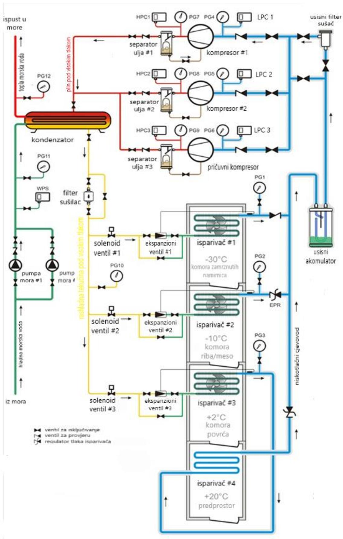
Slika 2: Shema cjevovoda rashladnog sustava provijanta trgovackog broda [3]
