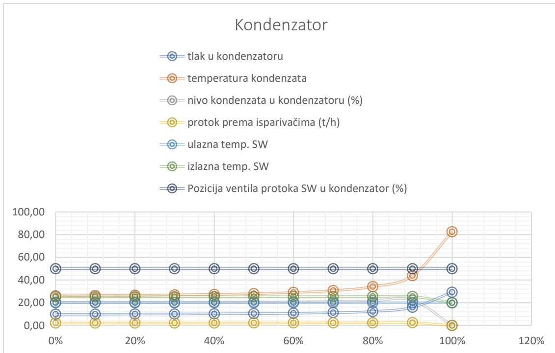
Slika 9: Vrijednosti parametara kondenzatora sw - more
