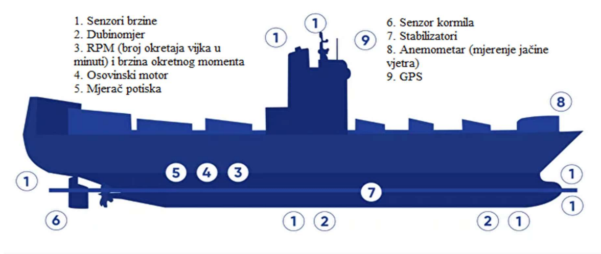
Slika 6 Primjer broda s položajima senzora za bilježenje podataka
