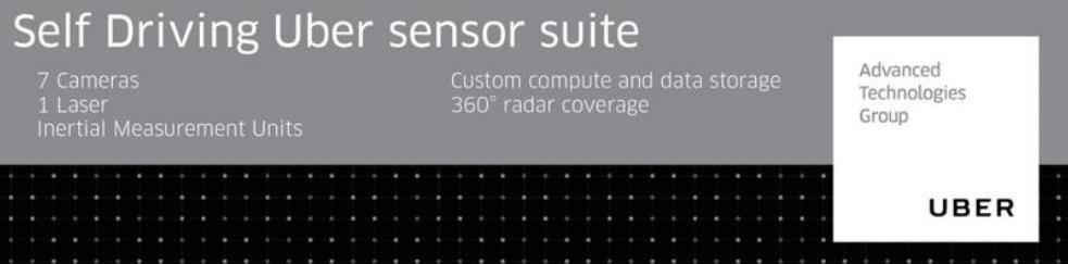
*Slika 1: Oprema autonomnog vozila*
