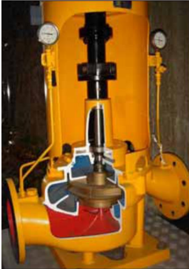
Slika 13: Presjek cirkulacijske pumpe glikola/vode [2]
