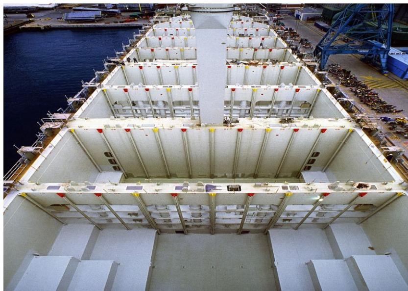
*Slika 25. Prikaz vertikalnih vodilica i skladišta broda*
