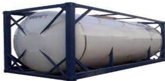
Slika 15. Prikaz tank kontejnera
