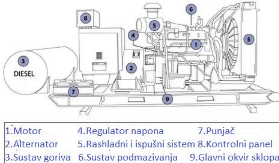
Slika 3 generator za nužnost
