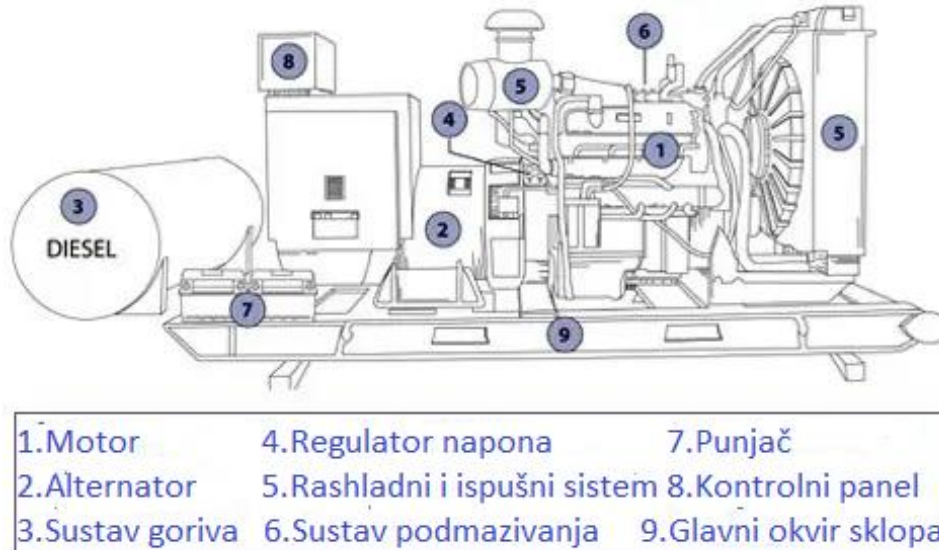
Slika 3 generator za nužnost
