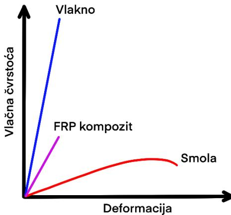
Slika 2 - Usporedba naprezanja i deformacija vlaknima ojačanog polimernog kompozita (eng. FRP – fiber reinforced polymer) i njegovih dijelova. [3]
