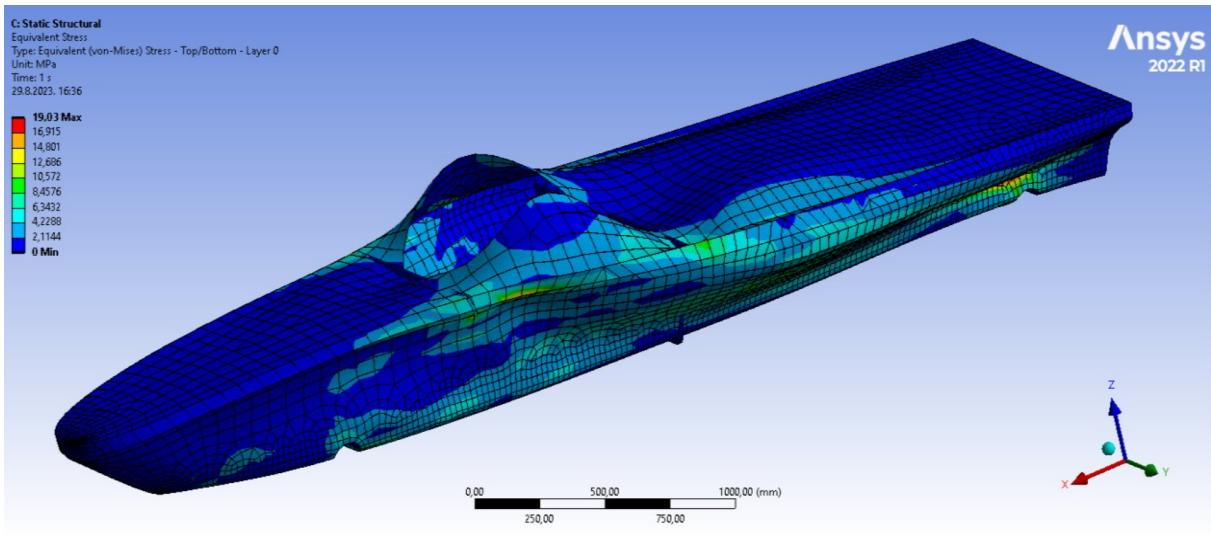
Slika 55 - Rezultati naprezanja analiziranog kokpita
