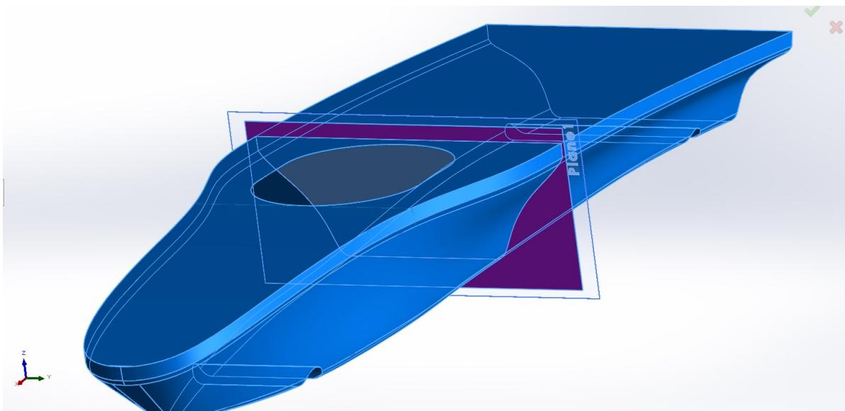
Slika 24 - Prikaz procesa kreiranja pregrade iza pilota
