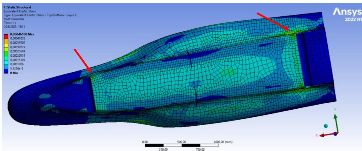
Slika 54 - Rezultat deformacije analiziranog kokpita (dno i bokovi)
