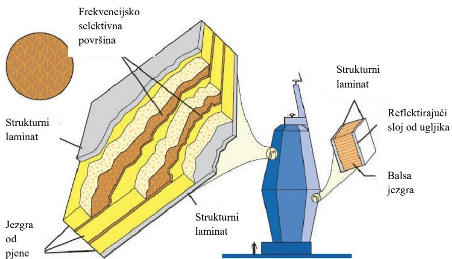
Slika 1 - Prikaz Naprednog Zatvorenog Jarbola/Senzora (eng. AEM/S)[24]
