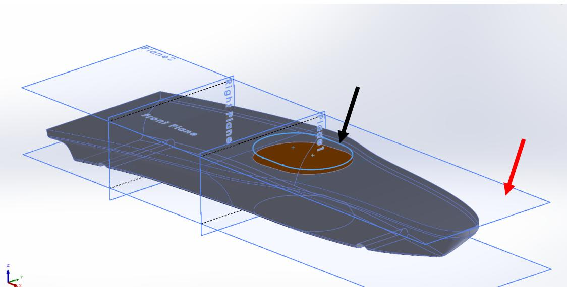
Slika 27 - Prikaz procesa kreiranja otvora za pilota
