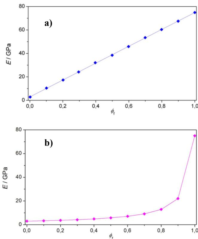
Slika 8 - Prikaz longitudinalnog a) i transverzalnog b) modula čvrstoće u ovisnosti o volumnom udjelu vlakana unutar kompozita (kompozitni materijala na osnovi poliestera ojačan staklenim vlaknima) [8]
