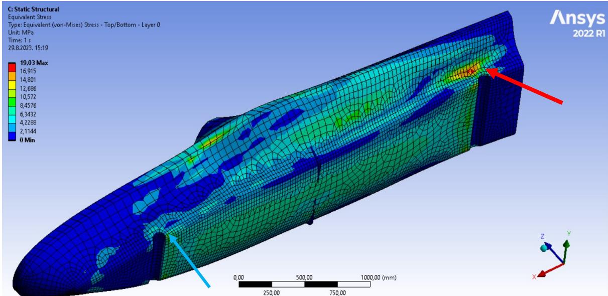
Slika 56 - Rezultat naprezanja analiziranog kokpita (dno i bokovi)
