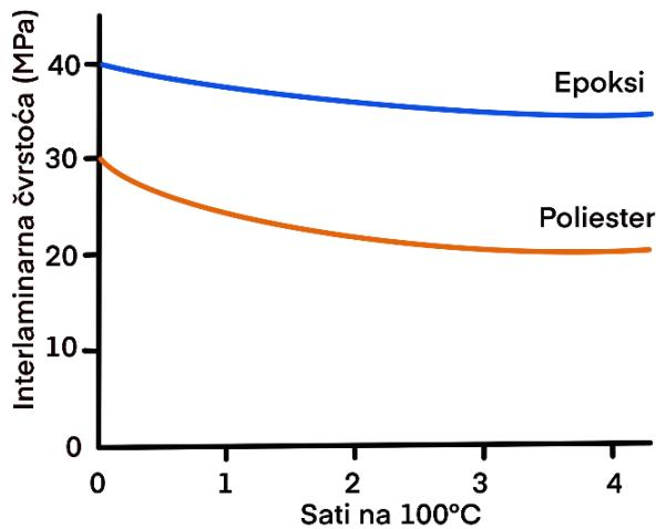
Slika 6 - Dijagram pada interlaminarne čvrstoće laminata [3]
