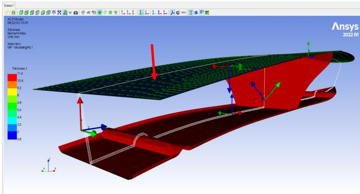
Slika 41 - Prikaz uzdužnog presjeka kompozitnog materijala kokpita
