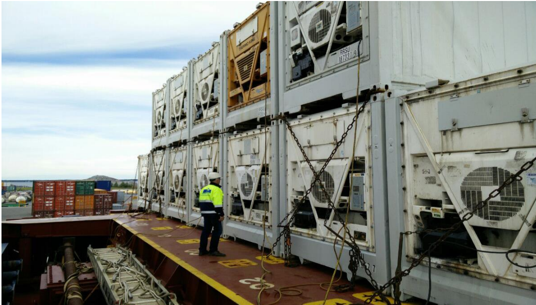
Slika 5. Prikaz rashladnih kontejnera na kontejnerskom brodu
