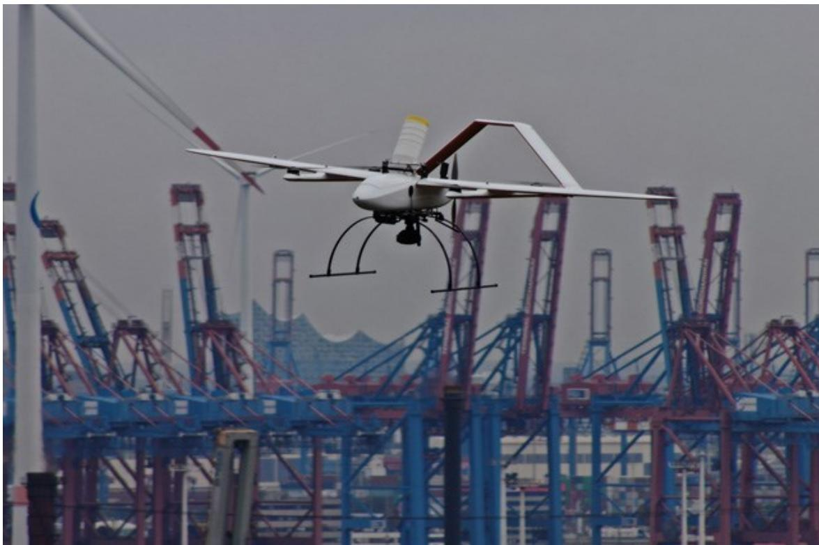
**Slika 5. Bespilotna letjelica kao mobilni senzorski sustav u luci Hamburg**
