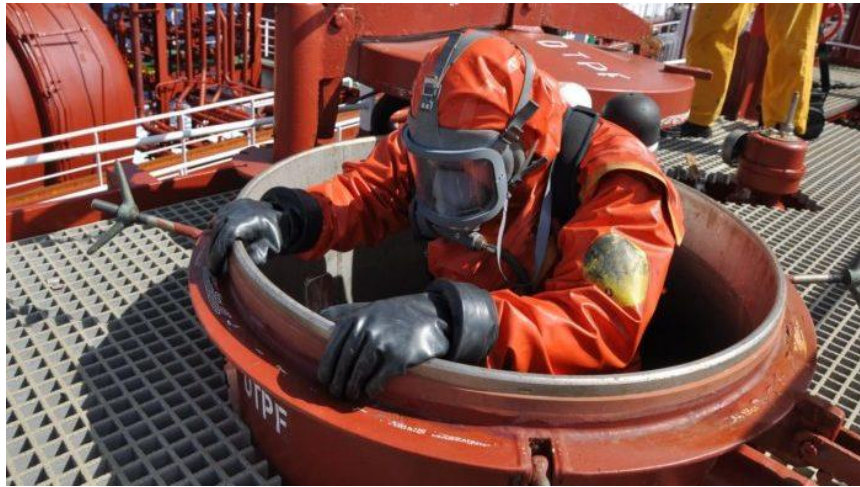
Slika 33: Obavezna upotreba aparata za disanje prilikom inspekcije tankova i neprovjetrenih skladišta
