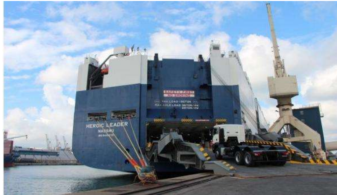
Slika 20. Krmena okretna rampa
